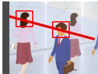
検知ラインを通過した人数を通過方向ごとに集計し、一定間隔でクラウドに送信します。
